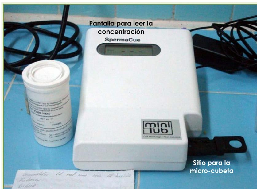
**Figura 4. SpermCue® utilizado para determinar la concentración espermática.**
