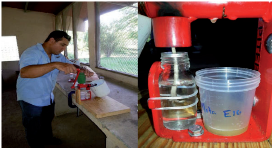
Figura 2. Proceso de extracción del aceite de jatrofa con prensa expeller.
